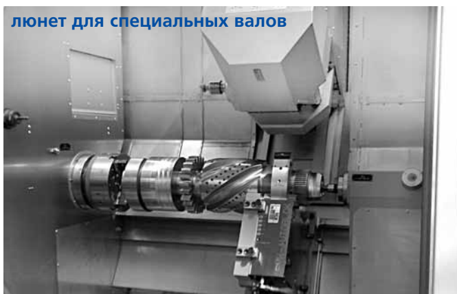
люнет с алмазными опорными сегментами для поддержки первичных валов при тяжелой проточке/шлифовке
