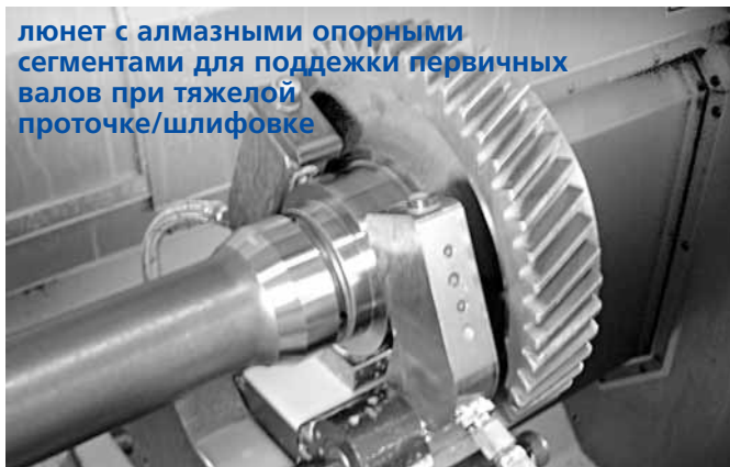
люнет для обработки валов в авиастроении
