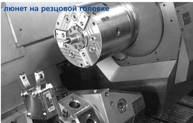
люнет для обработки валов в авиастроении
