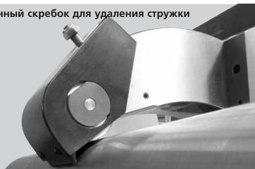
**Опция: подпружиненное устройство удаления стружки (только для SLU)**
