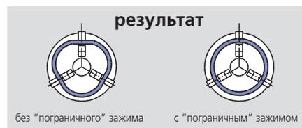
Результат – округлые детали с минимальной деформацией. "Пограничный" цикл программируется и полностью завершается в течение 2-4 секунд.
